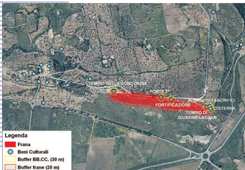
Fig. 4 Beni esposti al rischio da frana dell'area archeologica della Valle dei Templi nel comune di Agrigento (cerchiati in giallo), ottenuta mediante analisi spaziale tra le banche dati del Progetto IFFI e della Carta del rischio dei beni culturali.
